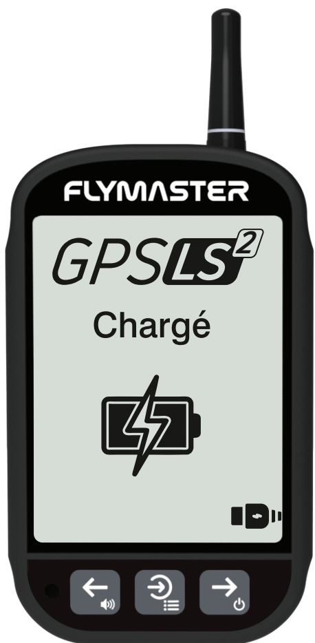
Le GPS LS2 est chargé à partir d'une source d'alimentation alors qu'il est éteint.
