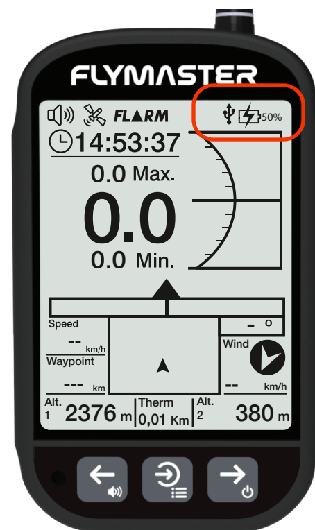
Le GPS LS2 est en cours de charge à partir d'une source d'alimentation externe alors qu'il est sous tension.
