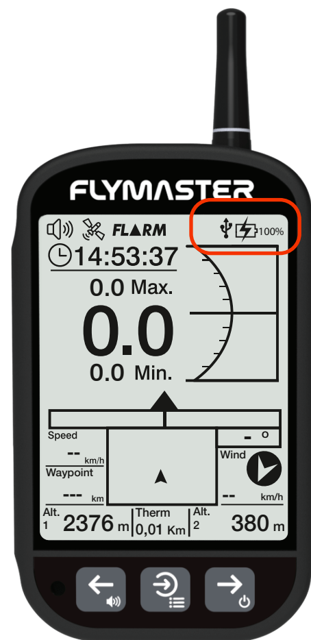
Le GPS LS2 est chargé à partir d'une source d'alimentation externe alors qu'il est sous allumée.
